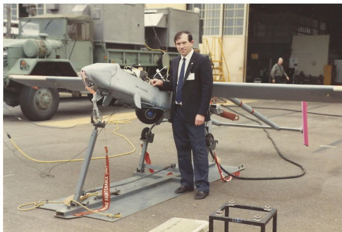
טיסות ניסוי של מזל"ט "פיוניר" שנמכר לצי האמריקאי. בתחתית המזל"ט מורכב "מטעד" התצפית (כדור שחור)
